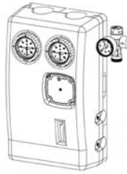
Solarna stacja pomp
